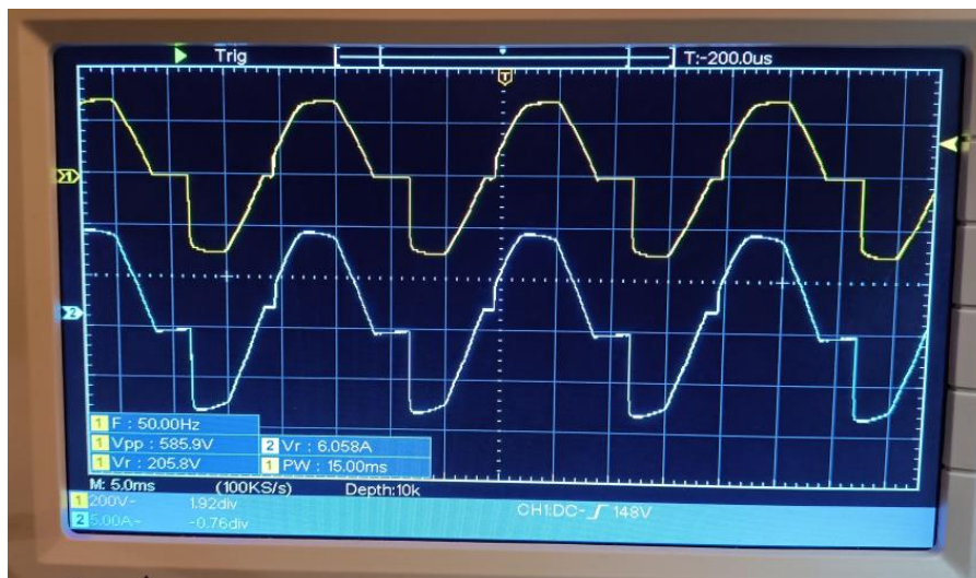
Oscillogramma della tensione e corrente con TRIAC in massima conduzione (ritardo minimo all'accensione)
