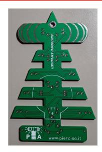
L'albero di Natale Tesla con 8 LED è circuito oscillatore basato su due transistor BJT NPN e pilota 4 LED rossi e 4 LED verdi in lampeggio alternato alla frequenza di circa un secondo. Si alimenta con una batteria 3V e si aziona a pulsante o anche in modalità continua tramite jumper.
