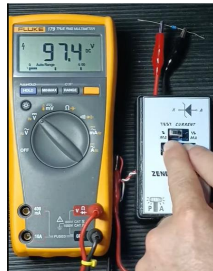
Test diodo Zener da 100V con corrente 5mA
