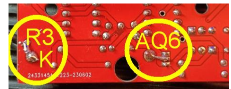
Filature da eseguire sul lato BOTTOM
