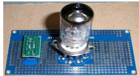
Scheda ibrida con montaggio di un modulo JFET e un doppio triodo noval
