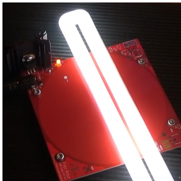
3 Scheda singola PCBTC in funzione con lampada a tubo NEON accesa
