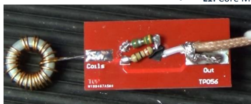
Assemblaggio della sonda di corrente
