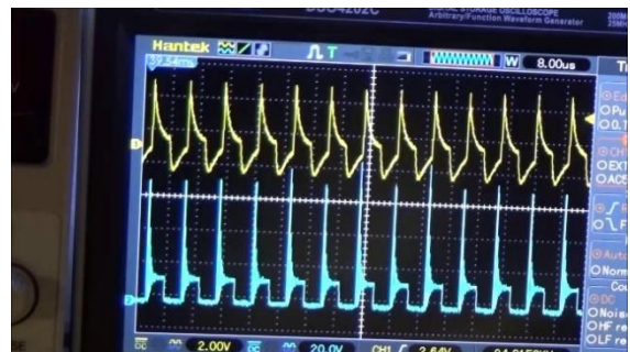
TEST con corrente impulsiva di 2A alla frequenza di 100KHz
