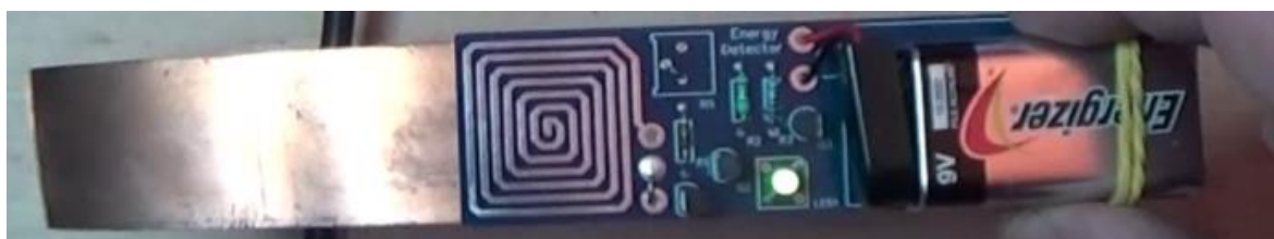
Modalità di funzionamento con estensione dell'antenna di rame saldato nell'area capacitiva sul lato inferiore del PCB
