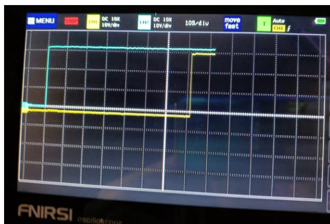
Oscillogramma Ritardo massimo: 10s/divisione Tensione di alimentazione (curva blu) e Chiusura del contatto (curva gialla)
